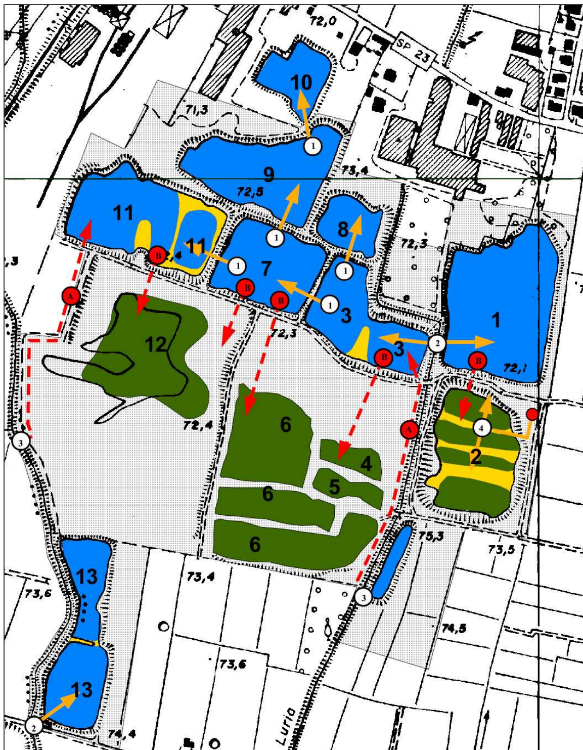
Figura 5.1 – Schema relativo all’ipotesi di progetto che prevede la realizzazione di un sistema di canalizzazioni scaricanti il troppo pieno degli sfioratori del R. Luria e del T. Luria nei bacini lacustri (in blu), a loro volta scolmati (nei momenti di eccessivi apporti idrici) nei bacini palustri (in verde) attraverso sistemi di sfioro adeguatamente dimensionati.
